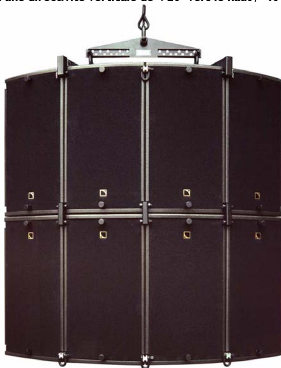
4 enceintes ARCS permettent d'obtenir une directivité horizontale de 90° et une directivité verticale de +20° vers le haut / -40° vers le bas
