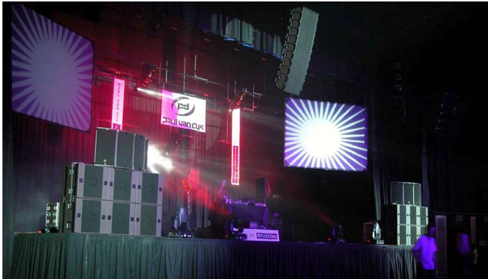
Figure 23: Système ARCS stacké (avec deux clusters de dV-SUB et un cluster central de dV-DOSC)
