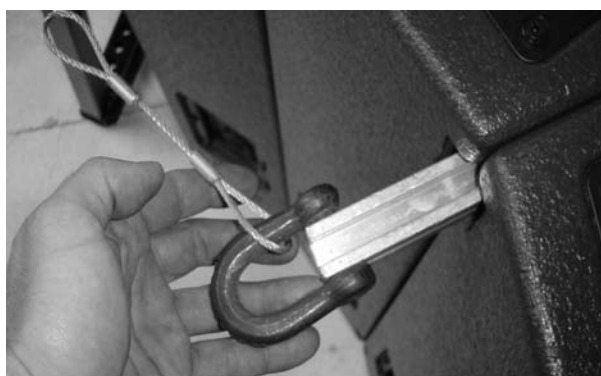
(2) Les élingues de sécurité sont accrochées entre les manilles des ARCOUPL.
