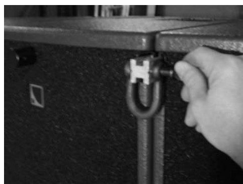
(8) Sécuriser l'ARCOUPL à l'avant.
