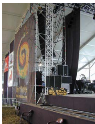
Figure 27: Systèmes side-fill et front-fill ARCS, posés au sol (3 x ARCS, 1 x SB218)
