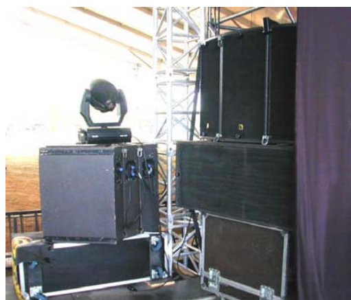
Figure 27: Systèmes side-fill et front-fill ARCS, posés au sol (3 x ARCS, 1 x SB218)
