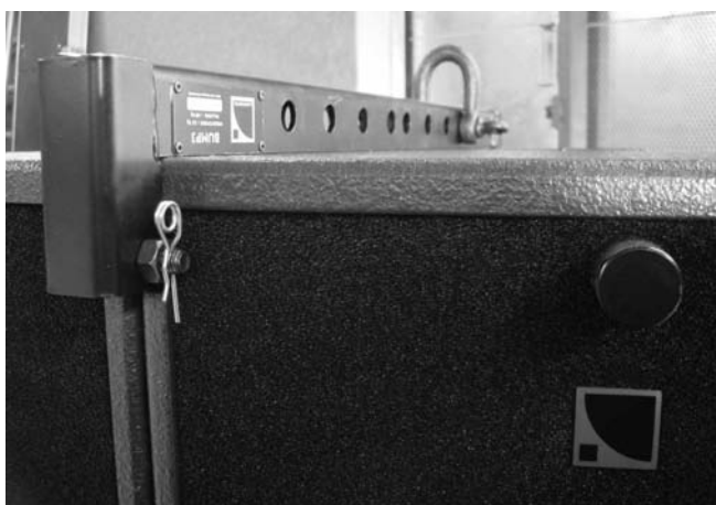
(13) Une fois le BUMP3 sécurisé, sélectionner le point d'accroche.
