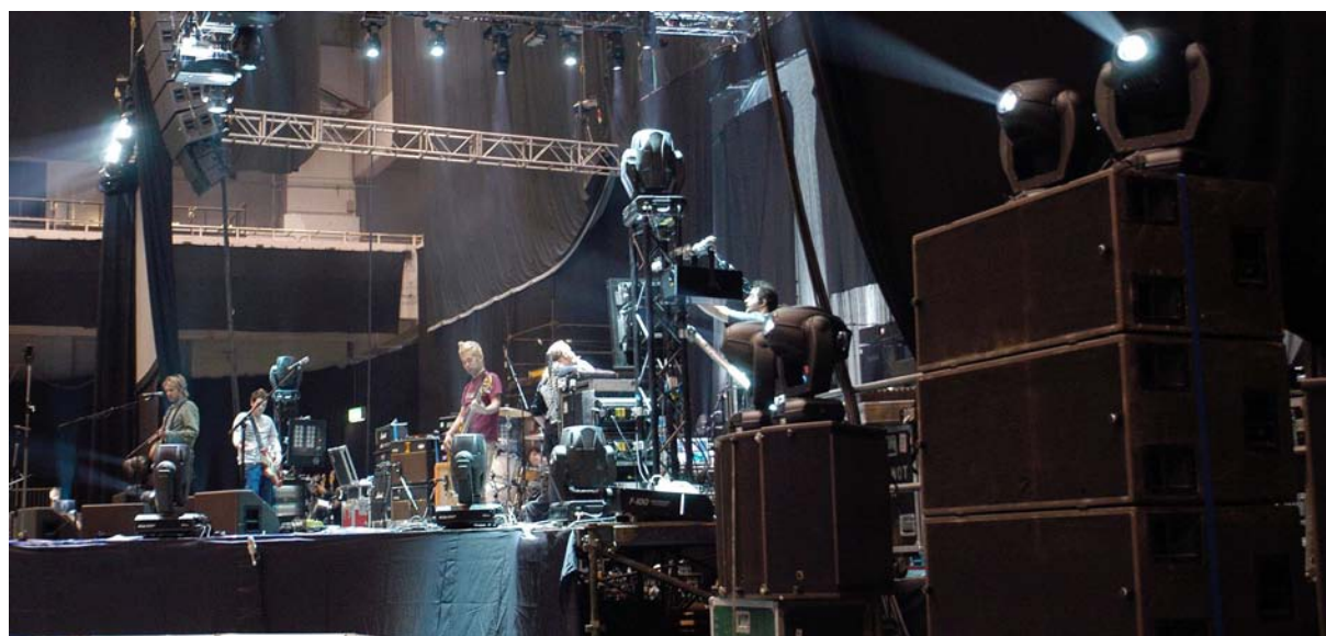
Figure 33: Système stéréo infill stacké (V-DOSC, dV-DOSC FOH gauche/droite)
