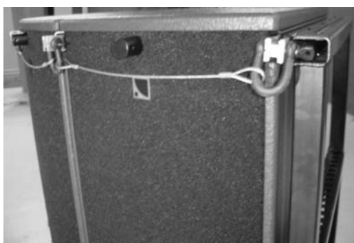
(7) Les élingues de sécurité permettent de solidariser l'ARCBUMP au cluster.
