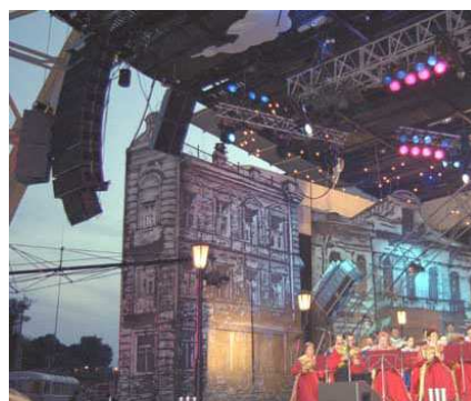
Figure 28: ARCS en renfort latéral (2+2 ARCS par coté)
