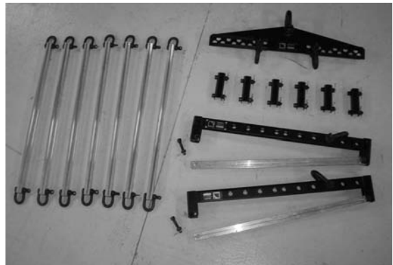
(2) L'accastillage nécessaire (10 ARCOUPL, 2 BUMP3, 1 LIFTBAR, 6 ARCSTRAP et les manilles).
