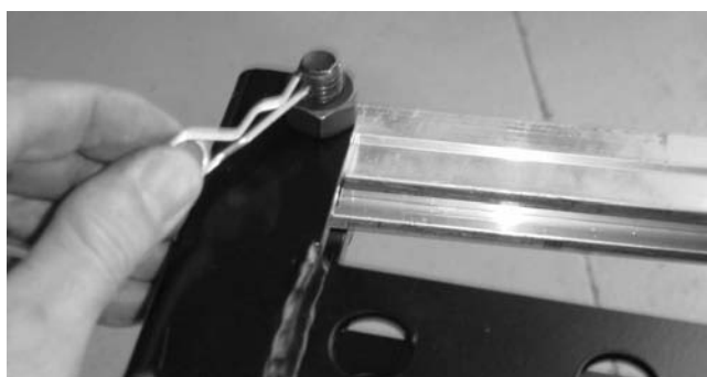
(11) L'ARCOUPL est sécurisé en utilisant la goupille de sécurité.
