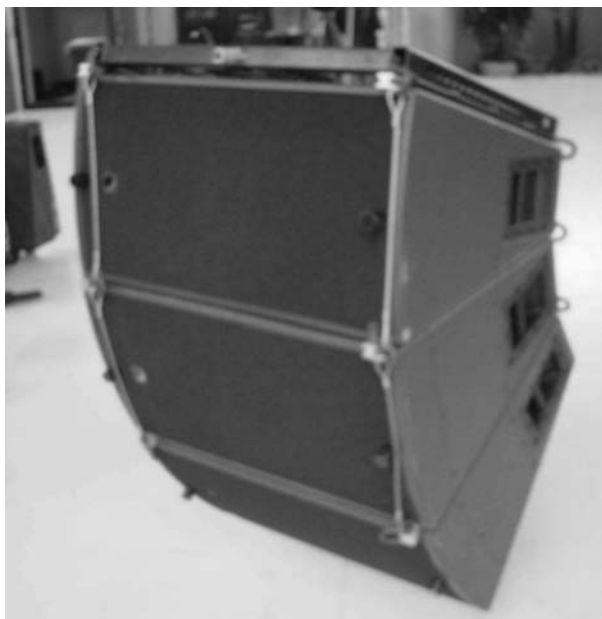
Figure 38: Procédure ARCBUMP pour l'accrochage de 3 enceintes ARCS horizontalement.
